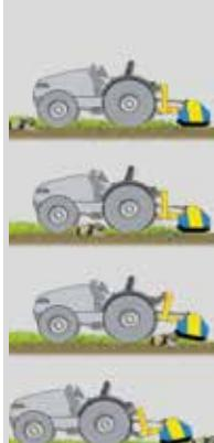
Togliendo il perno di sicurezza, permette alla trincia argini di seguire l'andamento del terreno.
